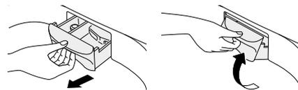
2 仕上剤投入口のケースのキャップをはずします。はずしたら、必ず取り付けてください。キャップを取り付けずに運転すると柔軟仕上げ剤が投入されません。
